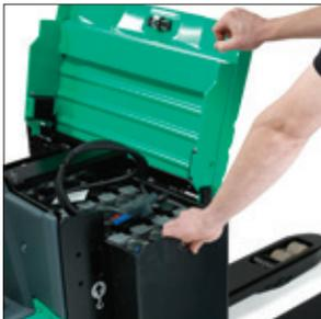
(PBP20N2E) Versátil compartimento de la batería con tapa sin bisagras
