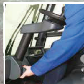
Columna de dirección totalmente ajustable
