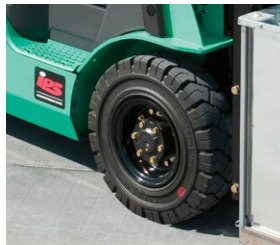
Ruedas neumáticas macizas de doble tracción
